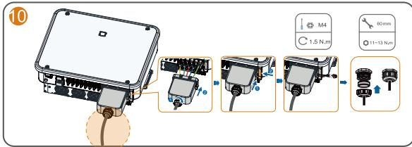
DC Connection / Conexión de CC / توصيل التيار المستمر / Anschluss Gleichstrom / Połączenie DC / Branchements CC / Conexión de CC / Collegamento CC / Conexiune CC / Conexão CC / DC-aansluiting / DC-liitánta / DC-anslutning / DC csatlakozás / Ligação CC / Подключение постоянного тока
