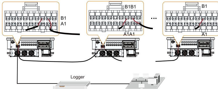
COM2 Connection (DRM) / Conexión COM2 (MRD) / COM2 (DRM) / توصيل COM2 (DRM) / Anschluss COM2 (DRM) / Połączenie COM2 (DRM) / Branchement COM2 (DRM) / Conexión de COM2 (DRM) / Collegamento COM2 (DRM) / Conexiune COM2 (DRM) / Conexão COM2 (DRM) / COM2-aansluiting (DRM) / COM2-liitintä (DRM) / COM2-anslutning (DRM) / COM2 csatlakoztatás (DRM) / Ligação COM2 (DRM) / Подключение COM2 (DRM)
